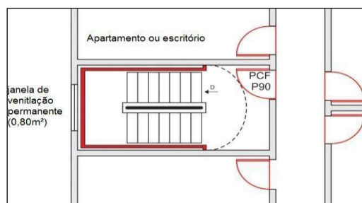
Figura 7 - Escada enclausurada protegida
