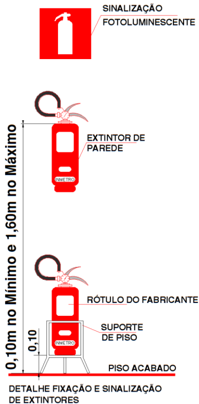
Figura 1 - Fixação de extintor de incêndio
